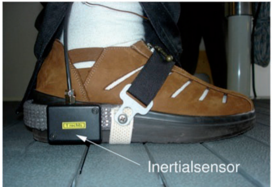
Abb. 1: Inertialsensor zur Triggerung und Regelung der Elektrostimulation am Schuh eines Patienten
